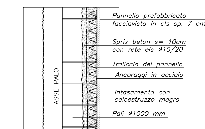
PARTICOLARE TIPO ATTACCO PANNELLO FACCIAVISTA SCALA 1:5
